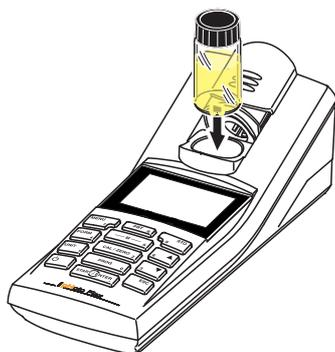
**16 mm-Küvette einsetzen**
